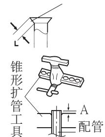
将锥形螺母（请务必使用分别附带在室内机组和室外机组上的锥形螺母）插入铜管，并用锥形扩管工具将铜管扩成锥形。
