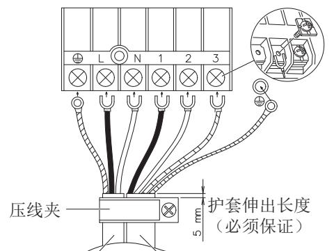
YZW 300/500 (电源线) YZW 300/500 (连接电缆)
