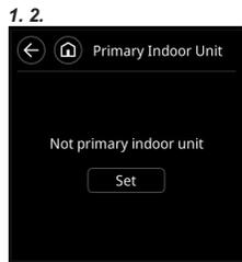
更改主室内机时, 除非事先取消当前主室内机的设置, 否则不能将另一个室内机设为主室内机。
